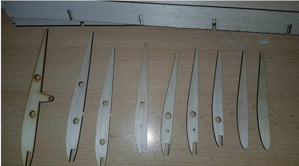
**Bild 11:** Übersicht Fläche Rippen und Endleisten.
