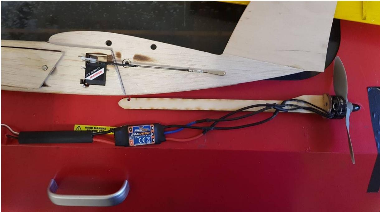
**Bild 09:** Hier sieht man Motorträger und Motor. Die Zungenöffnung dafür ist durch die davor liegende Bals-Schale verdeckt.
