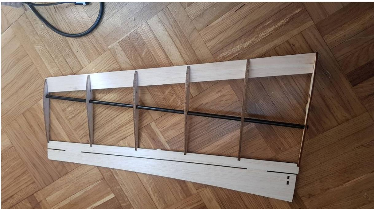
**Bild 12:** fertig aufgebaute Fläche. Die Querruder sind noch mit Stegen an der Endleiste befestigt. Die Stege werden später entfernt und die Anscharnierung erfolgt nach dem Bebügeln mit OroCover-Light z.B. mit Tesafilm.
