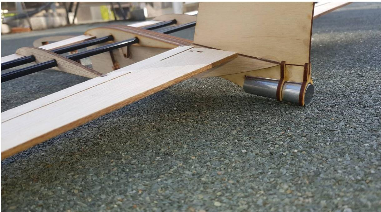
**Bild 10:** Heck des Atom: Eingebaute Motorträger-Zunge. Hier ist ein Raketeneinsatz geplant. Man erkennt im Hintergrund die Flächenbefestigung und im Vordergrund noch die abzutrennenden Querruderanteile.
