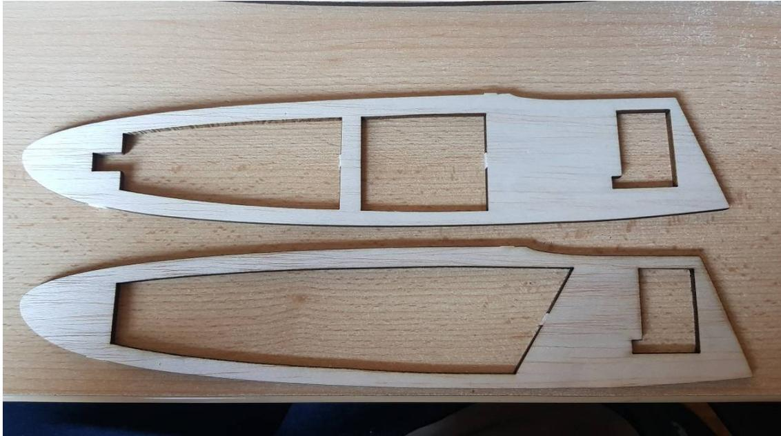
**Bild 01:** Rumpfaufbau großflächige Seitenteile. Man erkennt schon die späteren Servo-Sitze
