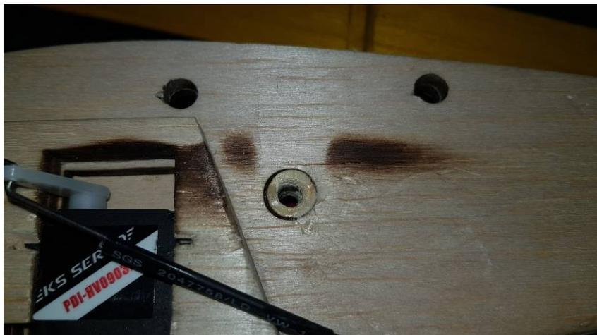
**Bild 07:** Zentrierhilfen für die Flächensteckung
