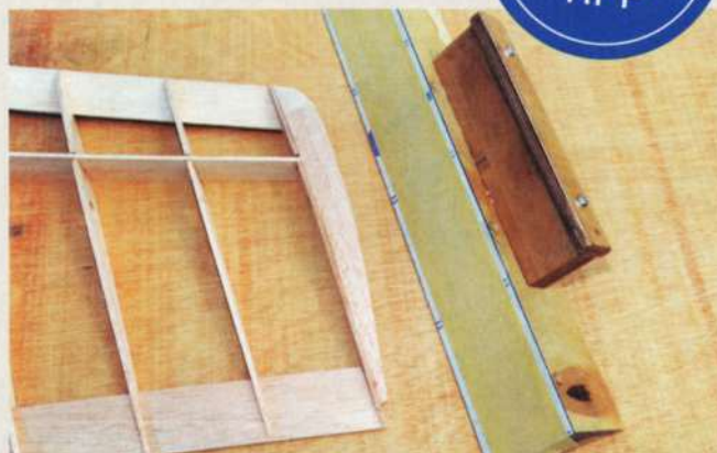
Beim Anschleifen der Auflagefläche beziehungsweise Füllklötze ist eine winklige Schleifplatte ein ideales Werkzeug
