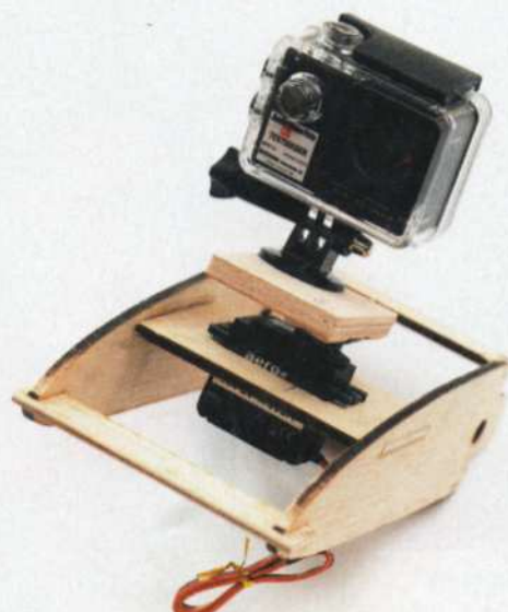
Der Kameraträger-Fronteinschub, der einfach zu montieren ist. Dank Servo lässt sich die Kameraperspektive flexibel ändern
