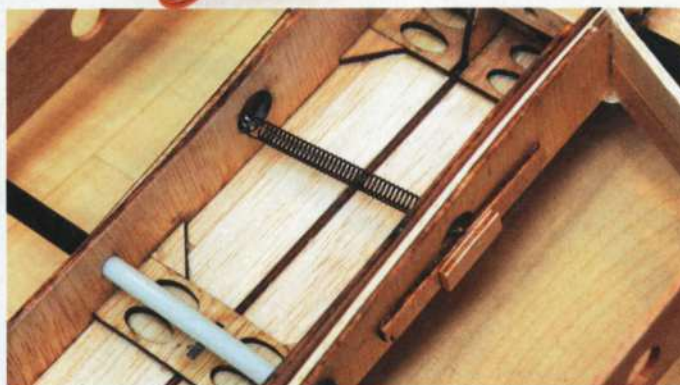
Die Flächen werden mittels einer Feder sicher gehalten. Die altbewährte Methode ist auch beim Dizzy Bird ideal
