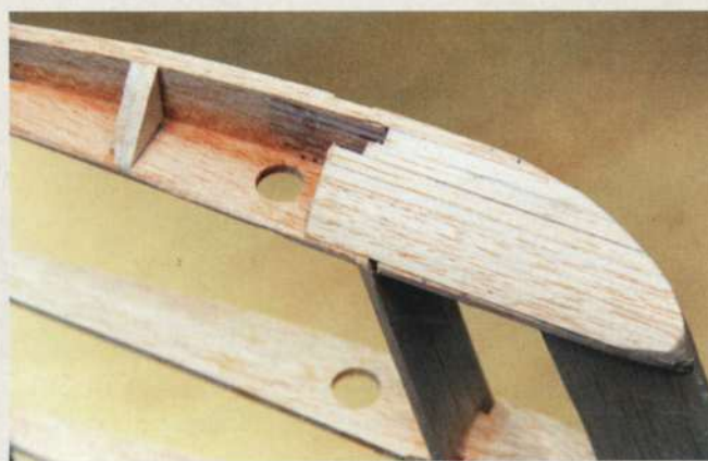
So angeschliffen ist eine größere Klebefläche für die Winglets gegeben
