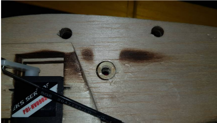
Bild 07: Zentrierhilfen für die Flächensteckung
