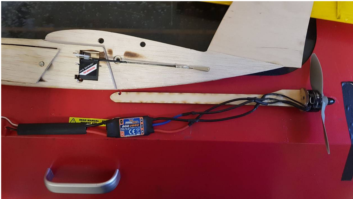
Bild 09: Hier sieht man Motorträger und Motor. Die Zungenöffnung dafür ist durch die davor liegende Bals-Schale verdeckt.
