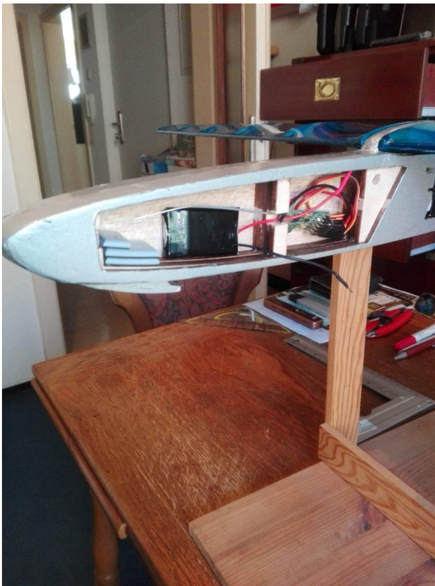
Bild 08: Einbau der RC-Anlage
