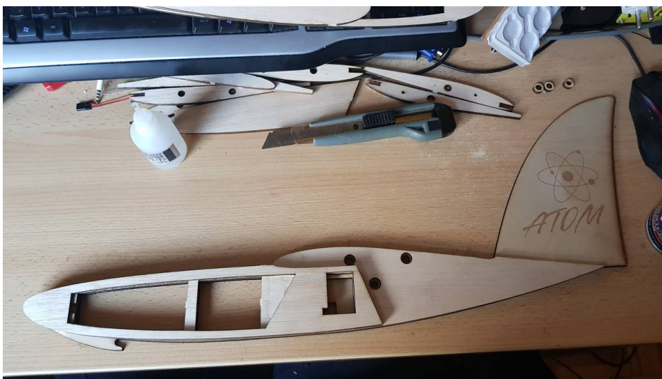
Bild 03: Fast zusammengebauter Rumpf. Die Motorträgerrippe in der Mittelrippe ist nicht eingesteckt.
