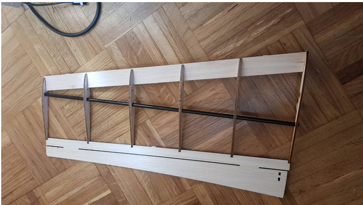
Bild 12: fertig aufgebaute Fläche. Die Querruder sind noch mit Stegen an der Endleiste befestigt. Die Stege werden später entfernt und die Anscharnierung erfolgt nach dem Bebügeln mit OroCover-Light z.B. mit Tesafilm.
