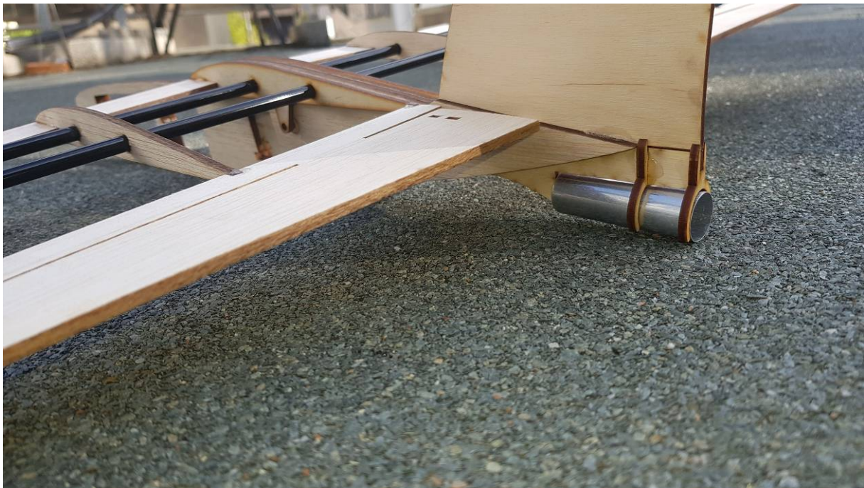
Bild 10: Heck des Atom: Eingebaute Motorträger-Zunge. Hier ist ein Raketeneinsatz geplant. Man erkennt im Hintergrund die Flächenbefestigung und im Vordergrund noch die abzutrennenden Querruderanteile.
