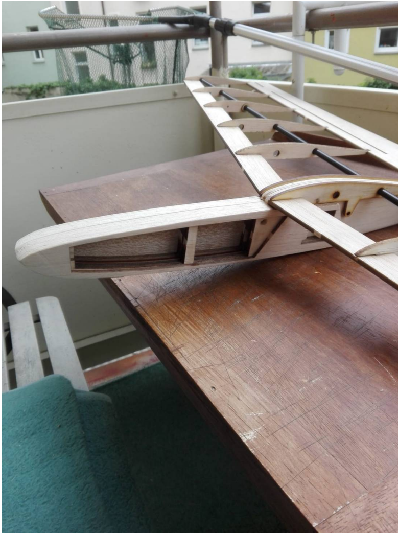
Bild 04: Hier sieht man den fast fertigen Aufbau der Rumpfkeule mit der Flächenbefestigung
