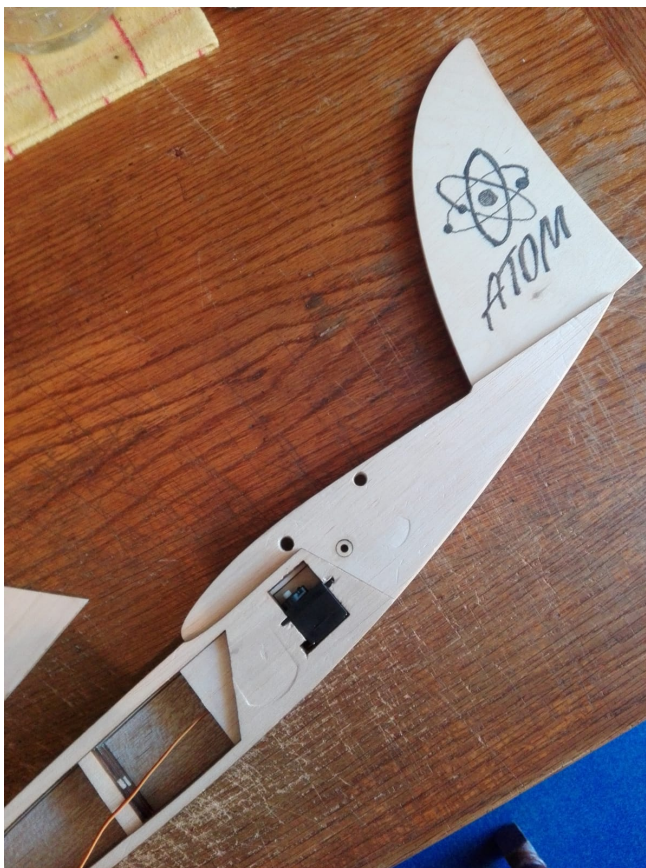
Bild 06: Servoeinbau und Flächenbefestigung
