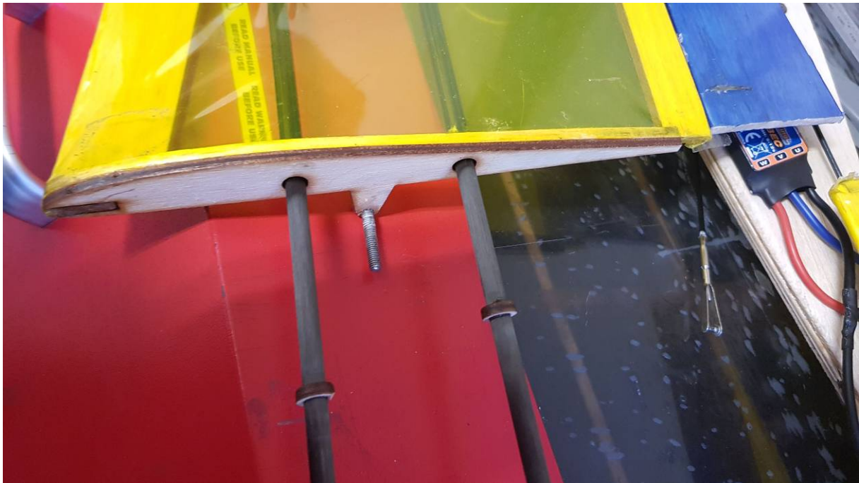
Bild 13: Bebügelte Flächenhälfte, CFK-Steckung und mit den Verstärkungsringen. Letztere dienen gleichzeitig als Zentrierhilfen.
